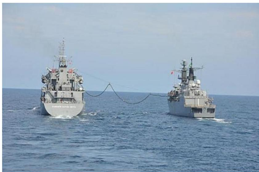
Transferência de óleo no mar do Navio –Tanque Almirante Gastão Motta para uma Fragata. Esta faina de transferência de óleo combustível, do navio tanque para um navio de combate, visa aumentar a autonomia, raio de ação, do navio de combate. Foto: CCSM
